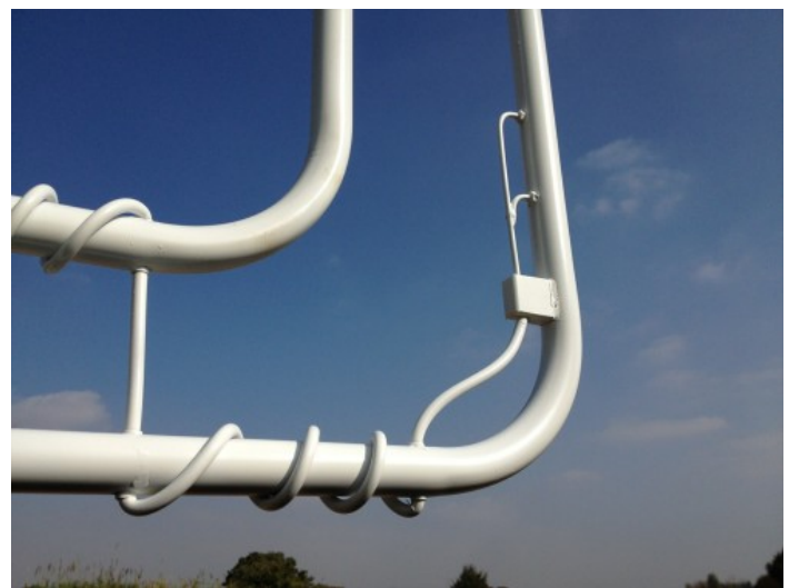
Vermoedelijk de inkoppeling. De sturing van de afstem condensatoren loopt nl. binnen de straler.
